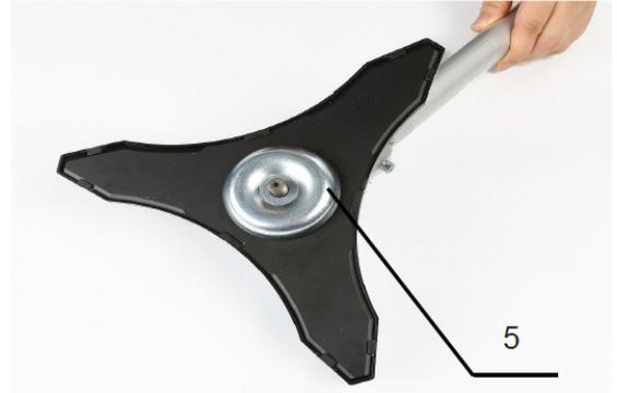
5. Montare il dado nella tazza, inserire la chiave esagonale attraverso il foro nella scatola degli ingranaggi per bloccare l'albero. Ruotare l'albero finché la chiave esagonale non è completamente inserita. Quindi serrare saldamente il dado con la chiave a bussola.
